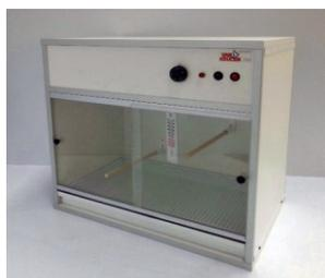
Mit mechanischem Thermostat bis 38° C, Warmluftzirkulation mittels Motor, Beleuchtung und Bodenrost.
